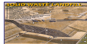
Depósito controlado con recuperación de biogás y lixiviado, y clausura
