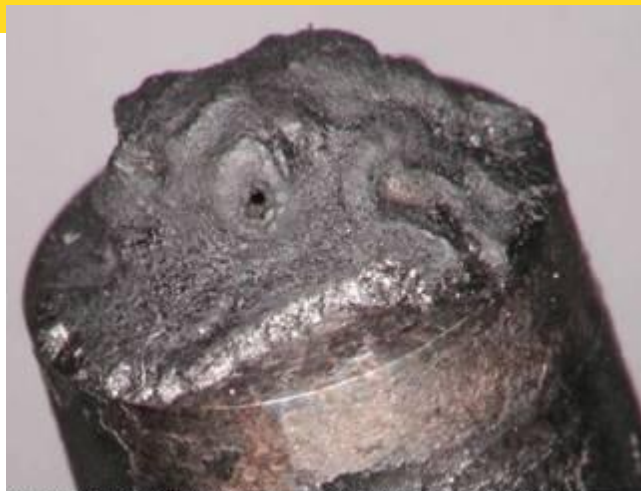
Abbildung 13: Verkokung an Düse 1 nach Prüflauf mit 50 % ROE/50 % DK
