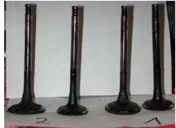
Abbildung 36: Ein- und Auslassventile nach Prüflauf 50 % ROE/50 % DK
