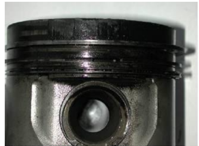
Abbildung 45: Kolben nach Prüflauf mit 25 % ROE/75 % DK
