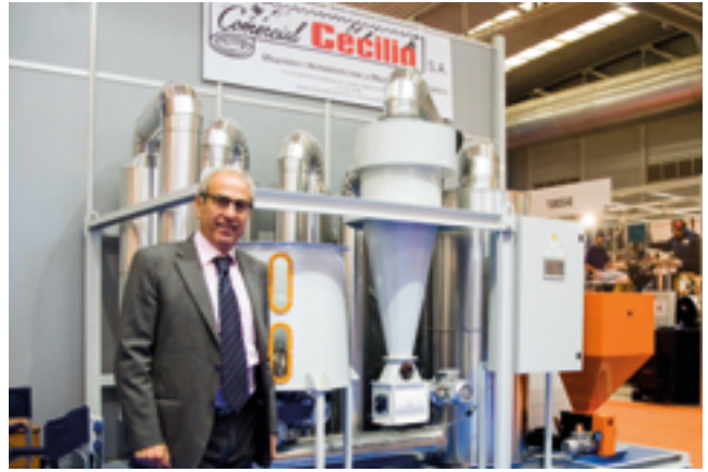
Roberto de Cecilio delante de una instalación de secado de partículas de alta velocidad, FLASH, de 200 kg/h de rendimiento. Fue presentada en la feria Expobiomasa 2017.
